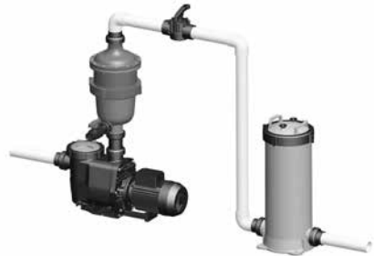
Installation standard avec un filtre à cartouche
