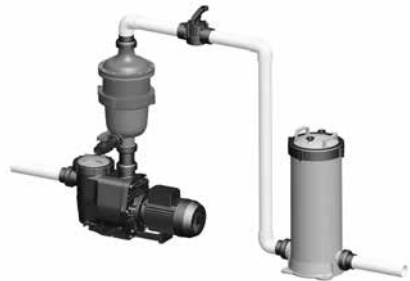
Typische Installation bei einem Filter mit Patrone
