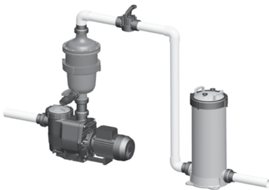
带二通截止阀滤芯式过滤器的安装
