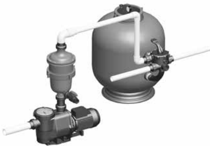
Typische Installation bei einem Medienfilter
