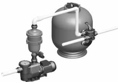
Installation standard avec un filtre à sable
